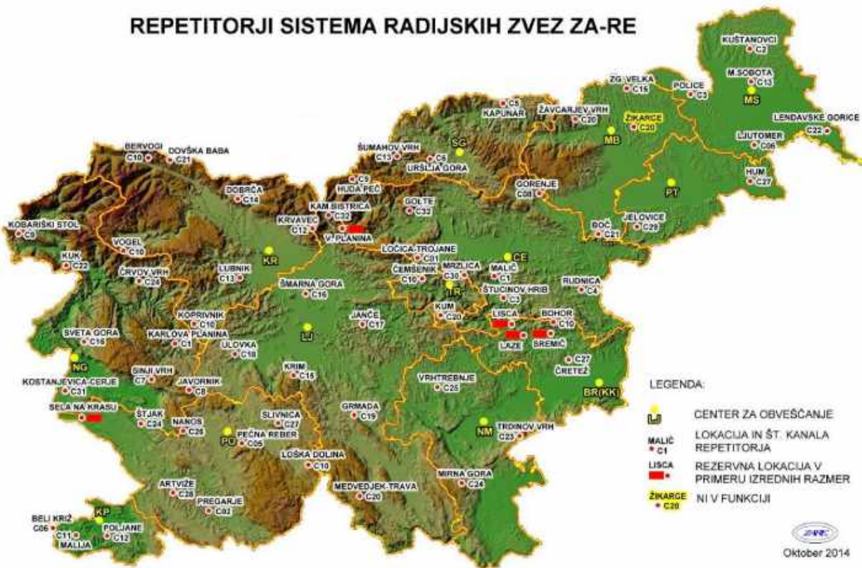
Slika 3: Repetitorske postaje s kanali sistema ZA-RE
